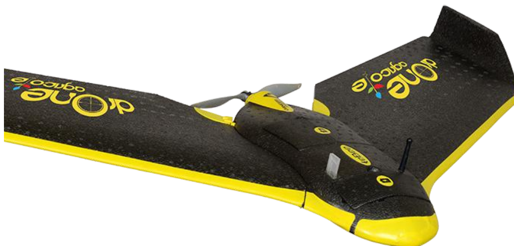
Un drone de Drone Agricole qui photographie les parcelles pour affiner l'épandage
